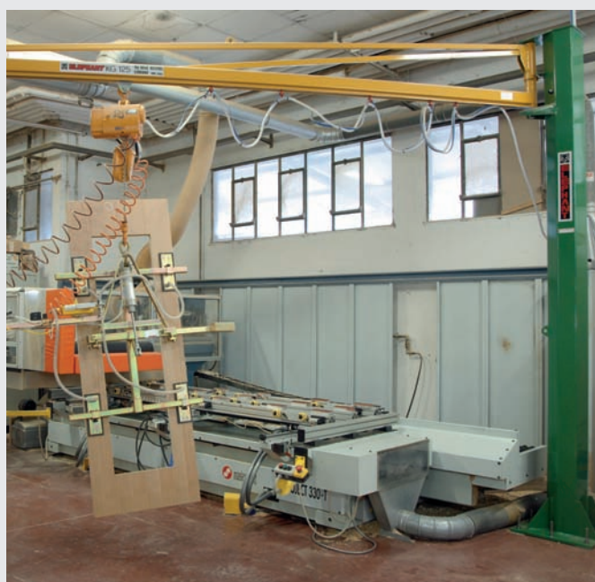
Gru a colonna con braccio in canalina, paranco elettrico Kito e ventosa a 4 piastre.
