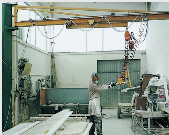
Gru a bandiera con braccio in trave con tiranti, paranco elettrico Kito e ventosa a 1 piastra.
