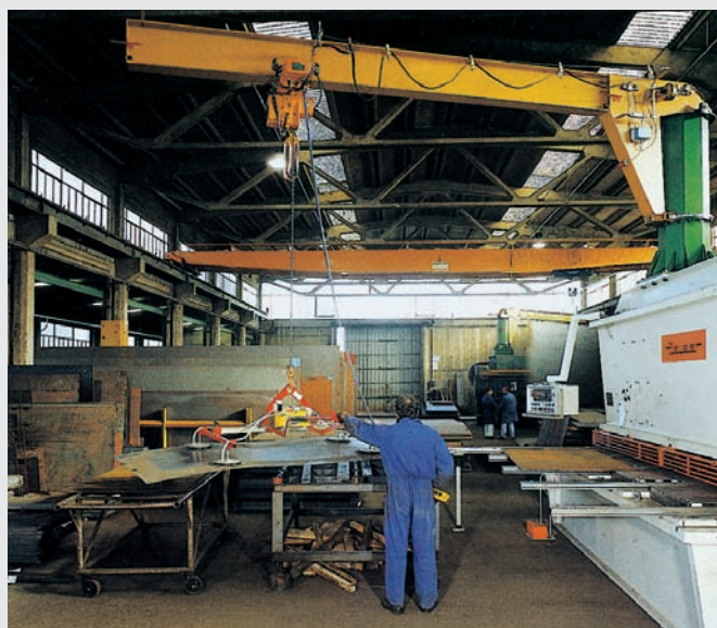
Gru a rotazione elettrica con paranco elettrico Kito e ventosa a 4 piastre.
