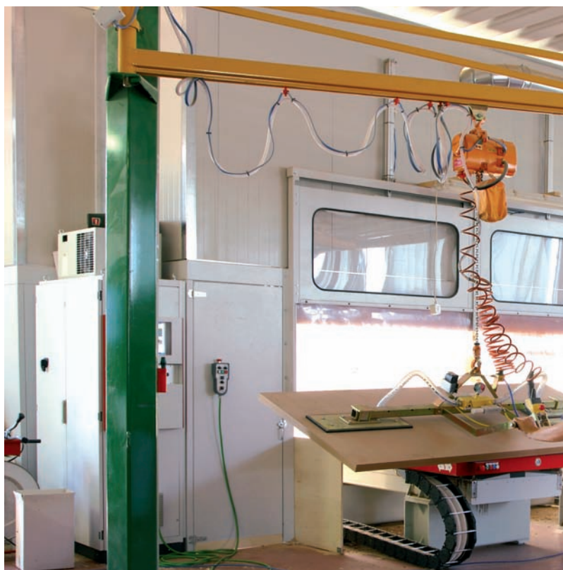
Gru a colonna con braccio in canalina, paranco elettrico Kito e ventosa a 2 piastre.
