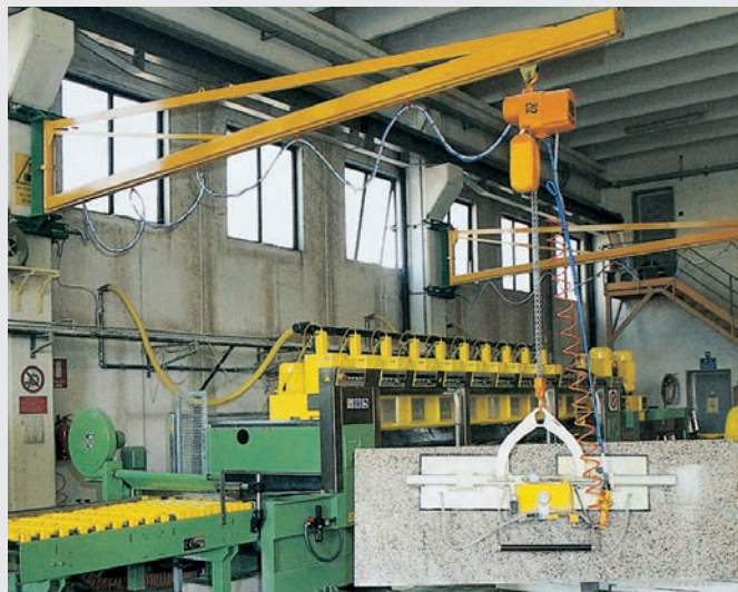
Gru a mensola con braccio in canalina, paranco elettrico Kito e ventosa a 2 piastre.
