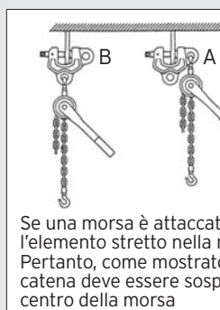
Può essere usata per supportare, trasportare e estrarre pezzi lavorabili da presse in funzione per l'arrotolamento o la piegatura
