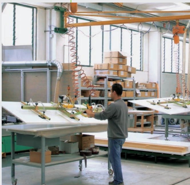
Gru a colonna con braccio in canalina, paranco elettrico Kito e ventosa a 6 piastre.
