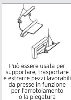
Sollevamento inclinato di flange sagomate di acciaio
