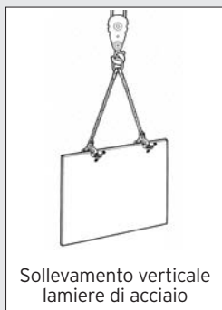
Sollevamento verticale lastre sagomate di acciaio
