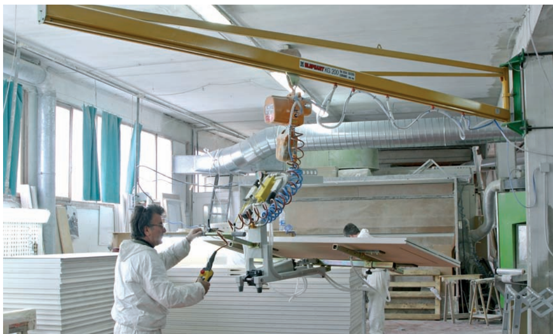
Gru a mensola con braccio in canalina, paranco elettrico Kito e ventosa in esecuzione speciale.
