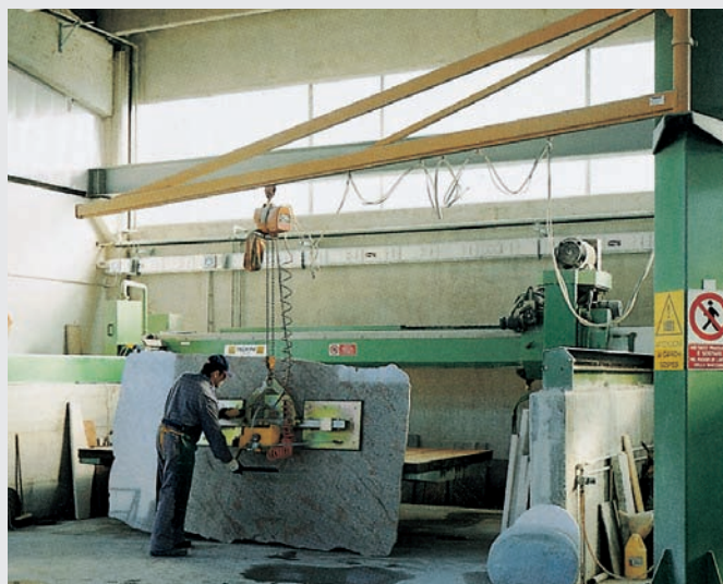
Gru a colonna con braccio in canalina, paranco elettrico Kito e ventosa a 3 piastre.
